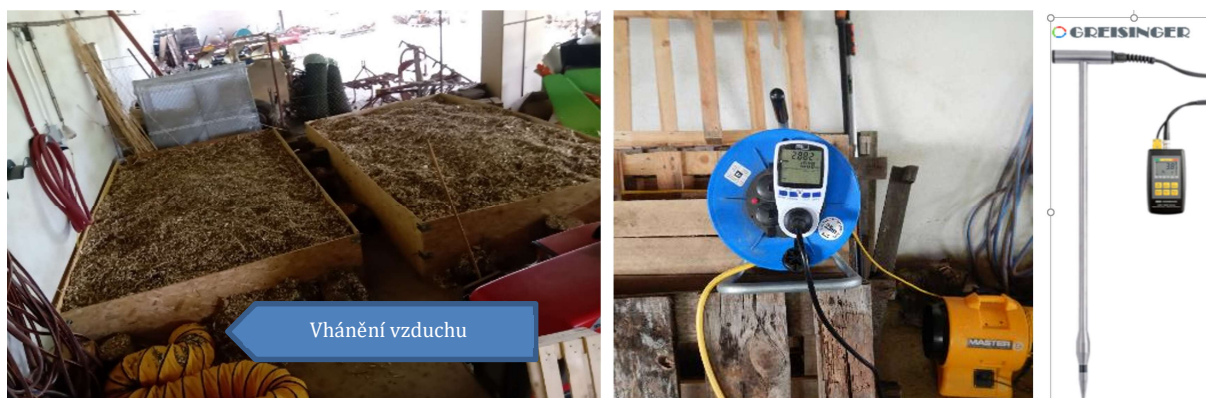
Obrázek 4.4-1 Experiment se sušením štěpky (zleva): kóje se štěpkou na dřevěném roštu – levý s nuceným proděním vzduchu, pravý bez (kontrola); elektroměr Solight a v pozadí větrák RAV 30; souprava pro měření vlhkosti štěpky GMH 38.
