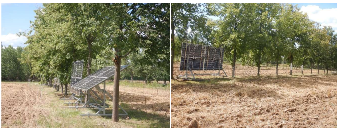
Obrázek 4.2-1 Umístění čidel pro monitoring teplot, vlhkosti vzduchu a půdy (TOMST) a srážek — na nosných tyčích 3 metry od linie stromů s PV panely na SV a JZ straně v experimentální agrolvoltaice Michovky (léto 2023)
