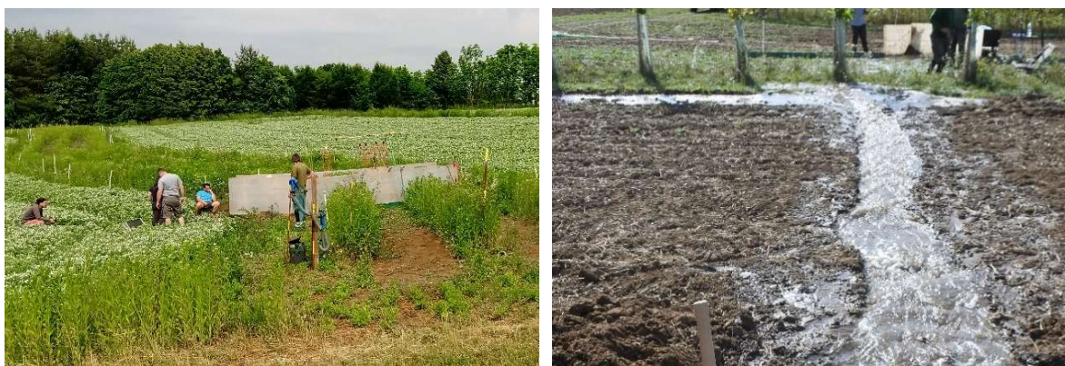
Obrázek 9 Demonstrace protierozního efektu 2 typů porostů dřevin na svahu 7–9 % při experimentálních zadržovacích zkouškách (VUMOP, VUKOZ, 2023); vlevo výmladkový pás RRD široký 6 metrů a simulace 100leté srážky – nulový odtok; vpravo jednořádkový pás ALS široký 2 metry a přelivová zkouška rýhové eroze – výrazné snížení odnosu půdy a rychlosti proudění. V obou případech se jedná o dřeviny 2 rok po výsadbě (výška 1–1,5 m).
